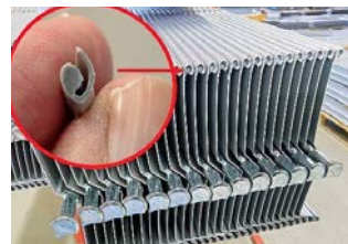
Zum Schutz vor Klappergeräuschen und Lackschäden wird in die Aussenkante der Aluminiumlamellen ein Kunststoffprofil eingewalzt.
