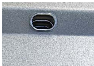
Beispiel für ein Qualitätsproblem: Schon nach wenigen Jahren riss hier ein unzureichend vernieteter Führungsbolzen aus der Lamelle eines Storens heraus.
