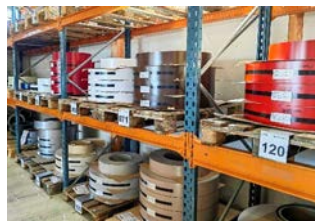
Ausgangsprodukt der Lamellenherstellung sind fertig lackierte Aluminiumbänder in zahlreichen Farbtönen.
